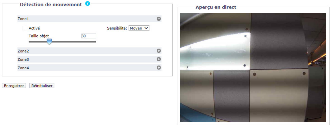
FIGURE 3-37 : RÉGLAGE DE LA ZONE DE DÉTECTION DE MOUVEMENT
