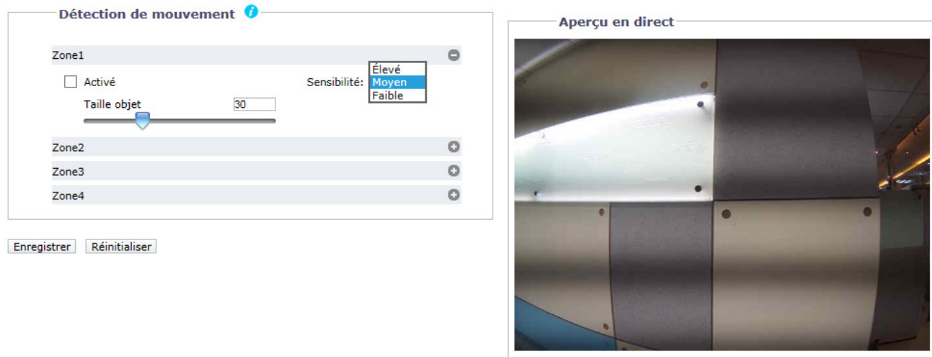
FIGURE 3-38 : ACTIVATION DE LA ZONE DE DÉTECTION DE MOUVEMENT
