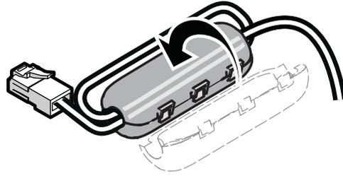
**Figura 3.** Montaje de ferritas con dos vueltas
