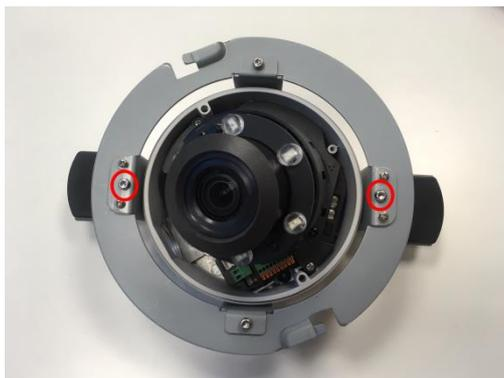
9. Réglez l'angle de l'objectif par mouvement panoramique et d'inclinaison. Pour procéder au réglage, saisissez la base du bloc comprenant l'objectif. Ajustez la rotation de l'objectif.
