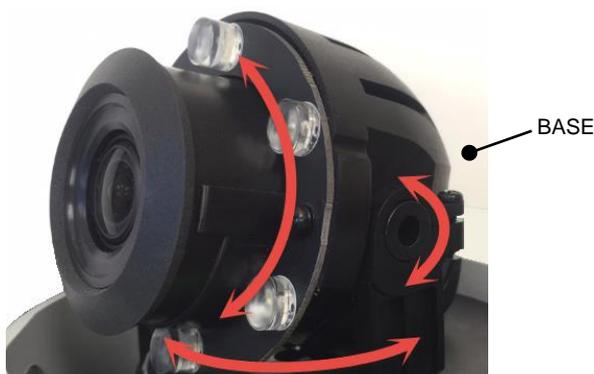
9. Serrez la vis de blocage afin de fixer la position du module de caméra.
