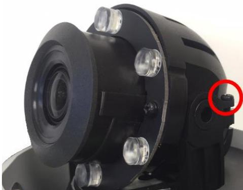
10. Installez la courroie du dôme si vous l'aviez enlevée, puis le dôme de protection, et serrez les vis du dôme de protection.
