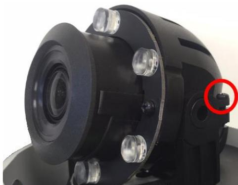
7. Installez la courroie du dôme si vous l'aviez enlevée, puis le dôme de protection, et serrez les vis du dôme de protection.
