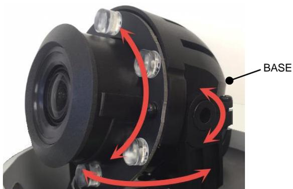
10. Serrez la vis de blocage afin de fixer la position du module de caméra.
